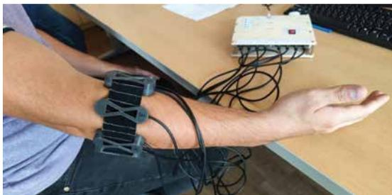
**Рис. 1.** Расположение датчиков в верхней трети предплечья
